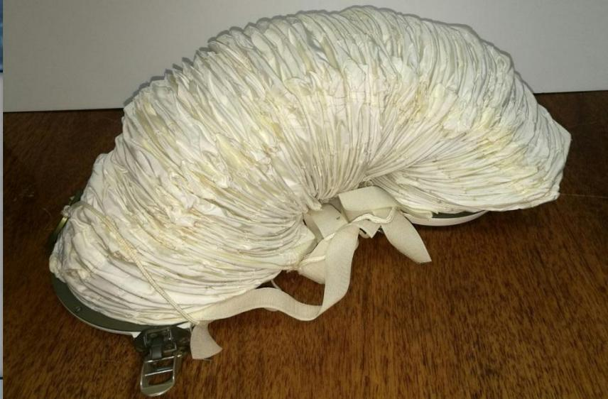
Рукава-воздуховоды. Монтируются и демонтируются силами экипажа. При хранении в сложенном состоянии занимают незначительный объем и рассчитаны на многократное применение.
