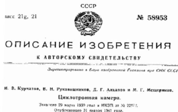
Предлагаемая циклотронная камера предназначена для получения мощных лучей нейтронов, эквивалентных излучению 100 г ртуты и больше, бомбардирующей внутри камеры дейтерием дейтоном же и путем «обстрела» внесенных коробчатых электродов (дуанта) тел, лучшими нейтронами (например, литием, ртутью и др.).
