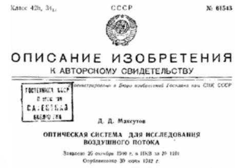
При исследовании воздушного потока в аэродинамических трубах возникает ряд вредных рефлексов от поверхностей защитных стекол. Предметом настоящего изобретения является такая оптическая система для исследования воздушного потока, проходящего нормально к оси системы между двумя защитными стеклами, которая в значительной мере устраняет вредные рефлексы в системе и даже вообще уменьшает потери на отражение.
